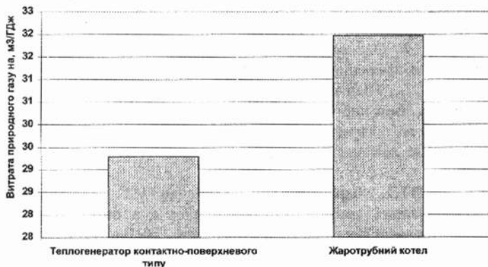
Рис.6 Витрата природного газу на 1 ГДж виробленого тепла теплогенератором контактено – поверхневого типу ТГа-2,0 в промислових умовах та жаротрубним котлом (розрахункова при ККД=92 %) протягом лютого 2012 р.
